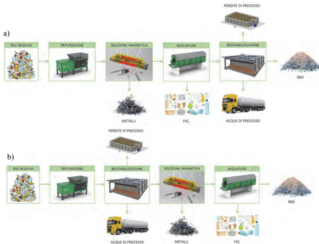
Figura 1 – Schema dell'impianto AMIU Bari con configurazione: a) flusso separato; b) flusso unico
